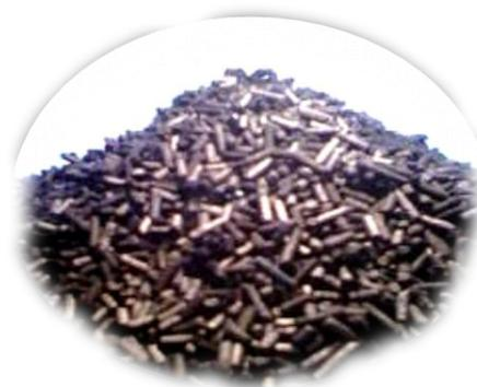
**Figure 2.6 : Charbon actif en bâtonnets (CAB)**
