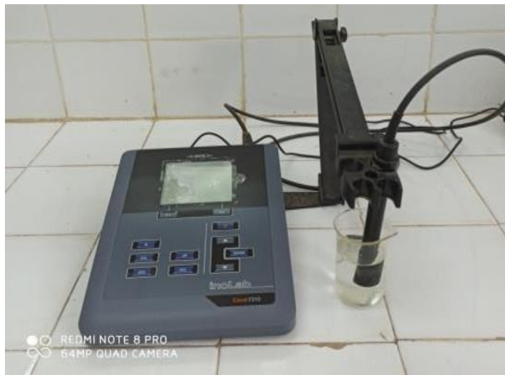
Figure 20 : conductivimètre au niveau du laboratoire de pédologie de INRF (Original, 2020).
