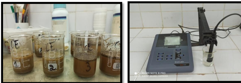
Figure 30 : Mesure de la conductivité électrique au niveau du laboratoire de l'INRF (Original, 2020)
