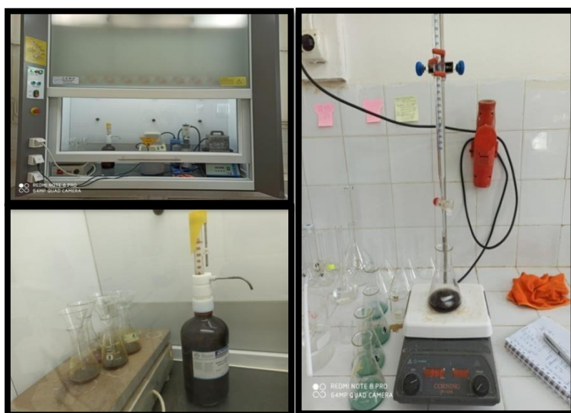
Figure 28 : Détermination de la matière organique au niveau du laboratoire de pédologie de l'INRF (Original, 2020)
