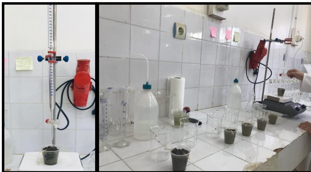
Figure 27 : Mesure de la porosité du substrat au niveau du laboratoire de l'INRF (Original, 2020)
