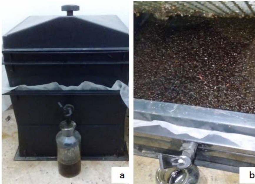
Figure 6 : Dispositif d'obtention du jus de vermicompost (a : le lombric ; b : les déchets ménagers).
