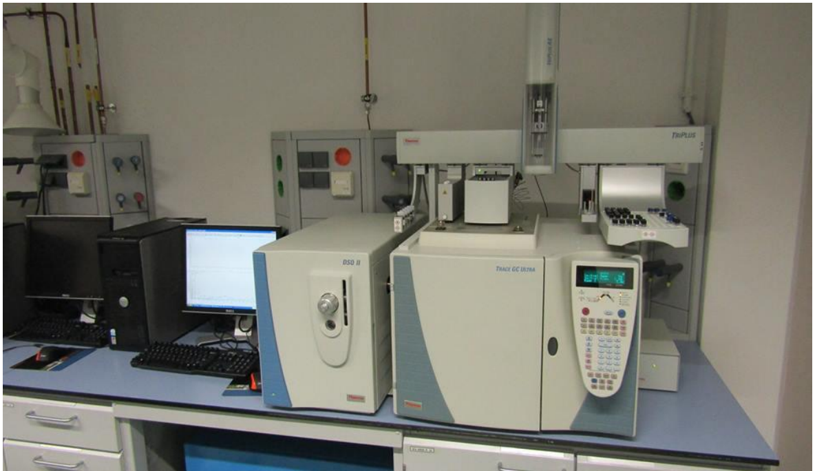
Chromatographe en phase gazeuse couplé au détecteur à un spectrophotomètre de masse de type : Trace GC Ultra DSQII
