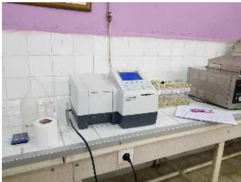
Figure 10. Lecture de la densité optique des échantillons avec le spectrophotomètre
