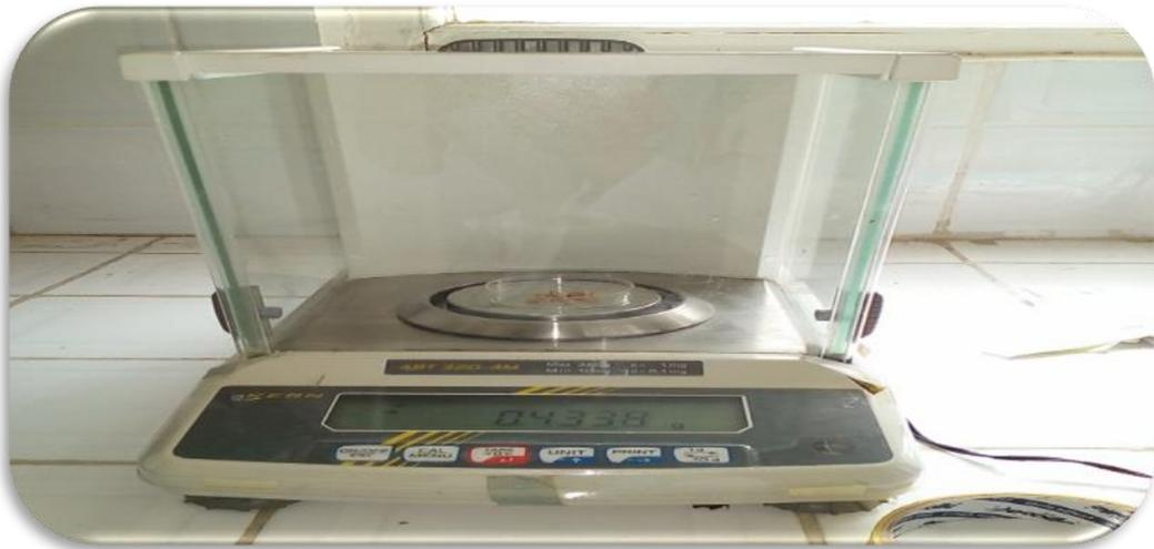
**Figure 3.14** : Mesure le poids de mille grains de blé dur.
