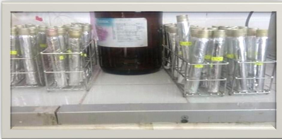
**Figure 18:** Préparation des tubes à essai pour le dosage de la chlorophylle (photos originale 2019).
