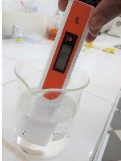
Figure 15 : mesure degré de PH de l'eau de source par un PH mètre (Photo originale 2019)
