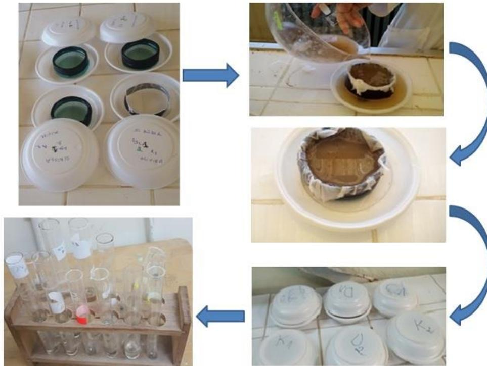
**Fig.13** : Les différentes étapes de la purification des nématodes par passage actif (Original, 2016).
