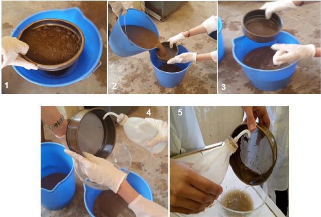
**Fig.12** : Les étapes d'extraction des nématodes du sol
