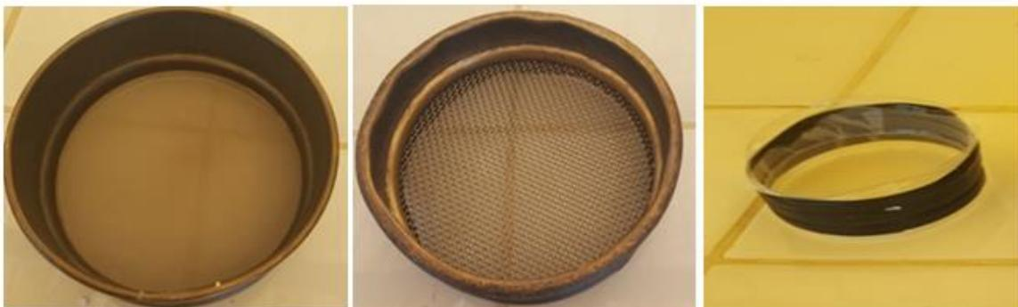
**Fig.11** : Différents tamis utilisés (Tamis à 90  $\mu$ , Tamis à 02mm, tamis en plastique)
