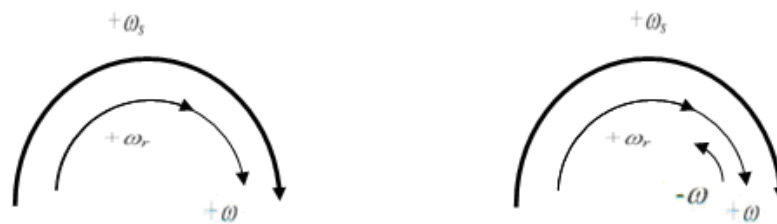
Figure.3.7 : fonctionnement de moteur sain et défaillant
