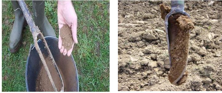
Figure10 : prélèvement d'échantillon de sol à l'aide d'une tarière (original, 2019)
