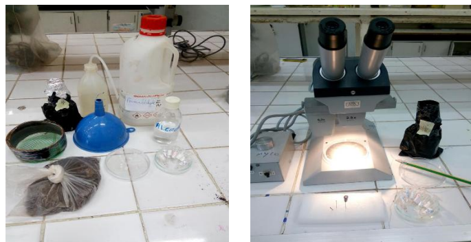
Figure12 : Matériels utilisée pour le Berlèse et l'identification de la pédofaune
