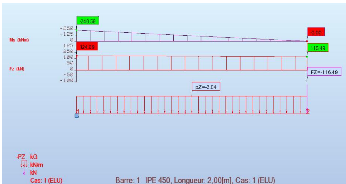
Figure 5. 9 : diagramme des efforts tranchant et des moments fléchissant à ELU.
