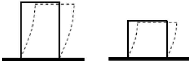
Figure 1.5 : Influence de la hauteur sur la déformée de la structure.
