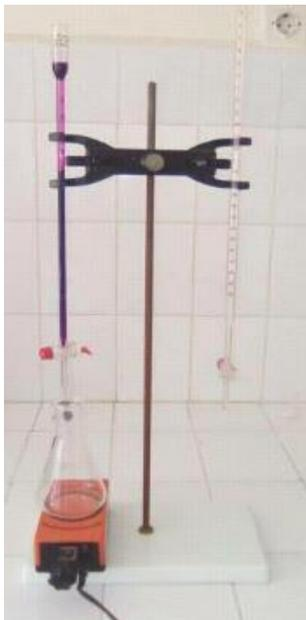
**Figure 40 :** Processus de titration (Photo originale).
