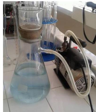
**Figure 39 :** Processus de filtration et récupération des tartrates de calcium (Photo originale).
