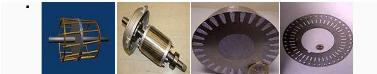
Fig. I.7 Structure d'un rotor en d'écureuil
