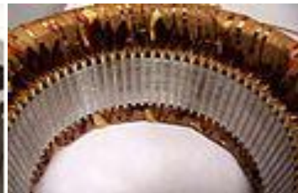
Fig. I.6 Stator d'une machine triphasée.
