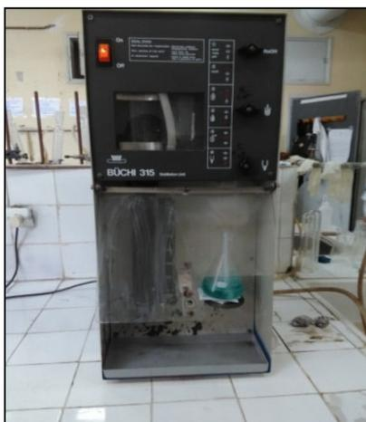
**Figure 17:** Appareil distillateur
