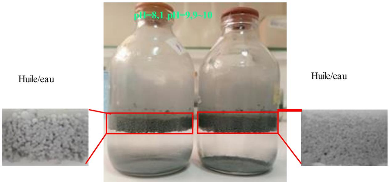
**Figure 4.14** : Taille d'émulsion huile/eau pour le pH=8.1 et pH=9.9~10
