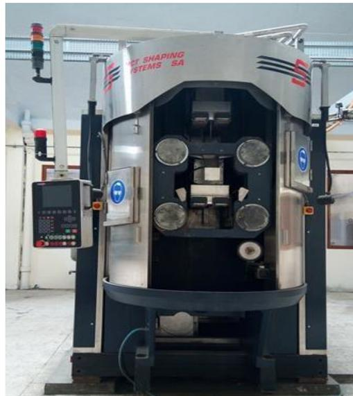
**Figure 1.10** : Machine de découpe de lingot du silicium multi-cristallin, HCT- CRTSE.
