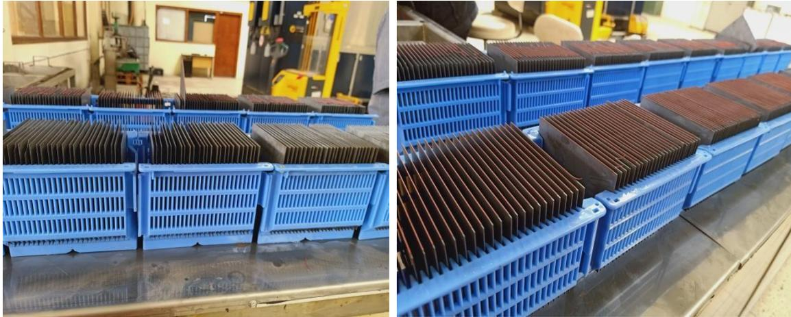
**Figure 3.4** : Plaquettes du silicium multicristallines obtenues après découpe
