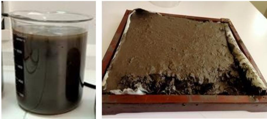
**Figure 3.5 :** *Slurry* phase liquide et boue après décantation
