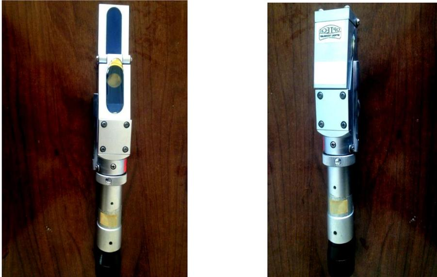
Figure 15 : Le réfractomètre
