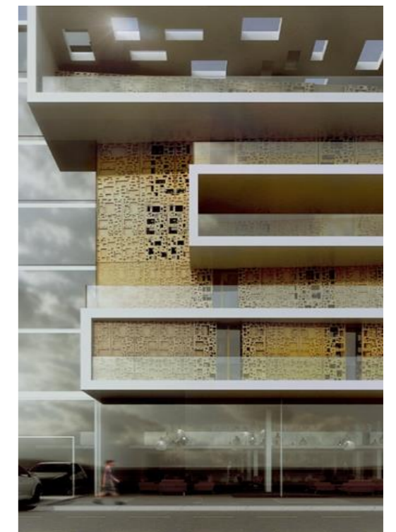
Figure 52 : Moucharabia protection solaire Source : amush .org
