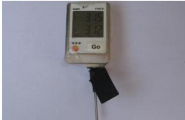
**Figure 26 :** Enregistreur de température de type testo 175 T2 (photo original)
