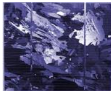
Fig (I-9) : Cellule polycristallin
