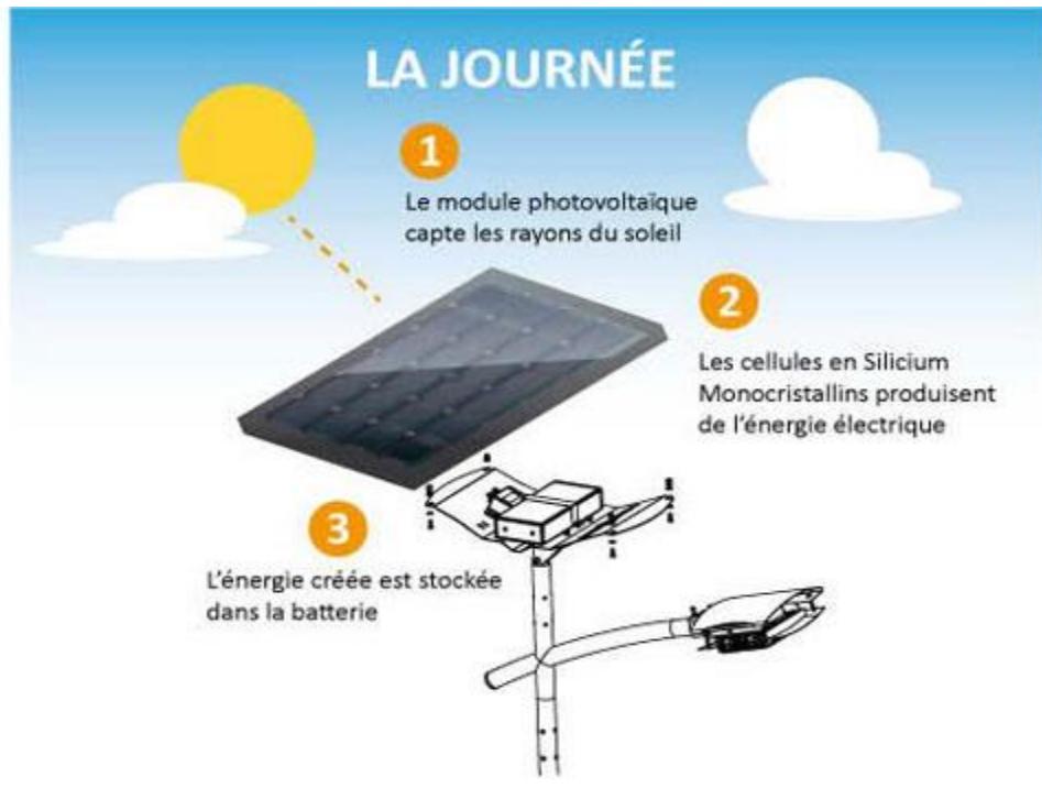
Fig (III-1) : Fonctionnement du lampadaire solaire dans la journée
