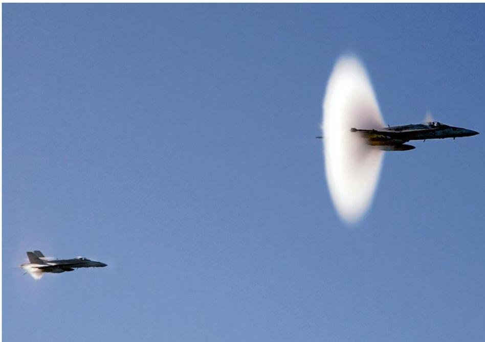
Figure (I.4) : un avion passe le mur du son [18]
