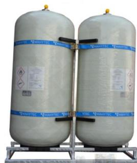
Le réservoir utilisé dans l'étude est un réservoir de 850 L, il peut stocker environ 4,2 kg d'hydrogène à 60 bars. Couplé à un électrolyseur, l'hydrogène généré peut être directement stocké sans compression. Ce réservoir de type 4 est léger, ce qui le rend idéal pour les applications sur des sites éloignés [41].
