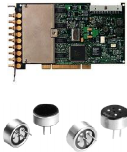
Figure 4. 2. La carte NI PCI-4472B et les microphones WM-54B
