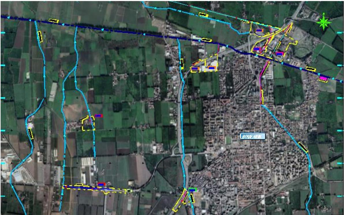
**Figure IV.1** : plan de la variante 01 de la protection de la ville de Boufarik contre les inondations.
