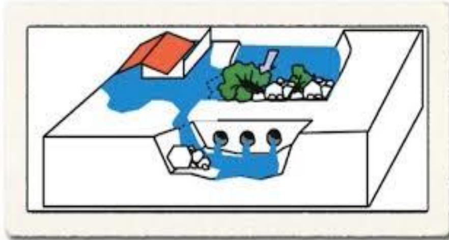
**Figure I.10** : Inondation par rupture de protection
