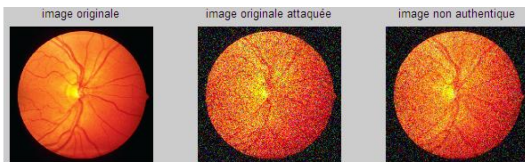
Figure4. 39 Image médicale couleur tatouée par une signature multiple attaqué par un bruit gaussien.
