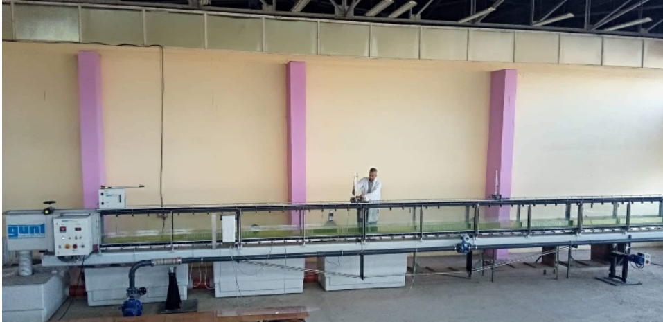
Figure II.1 : Canal à pente variable
