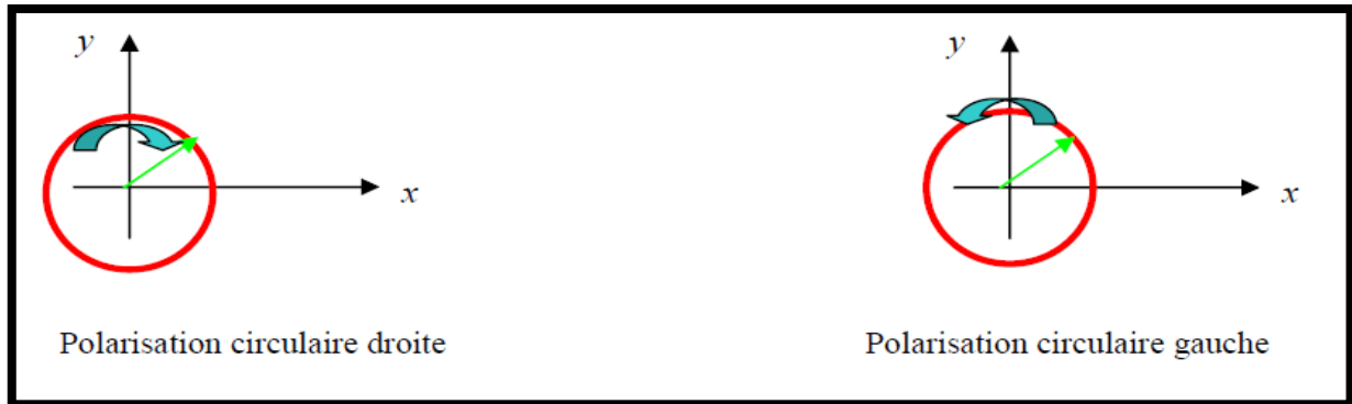
Figure I.13 : Exemple de polarisation circulaire du champ électrique E.
