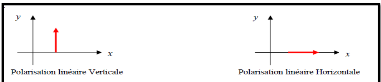
Figure I.12 : Polarisation linéaire du champ électrique E .
