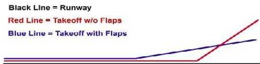
Figure III.2- Schéma explicatif pour un décollage avec flaps et sans flaps.
