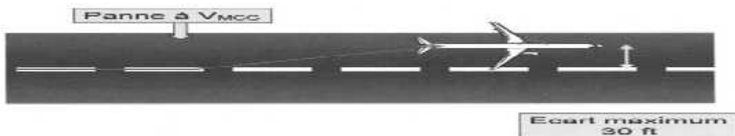
Figure .2- Vitesse minimale de contrôle au sol. [9]
