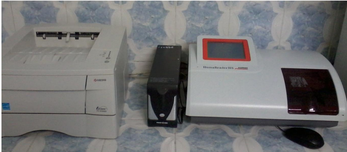
Figure 24 : Lecteur des densités optiques (spectrophotomètre 420-620 nm)
