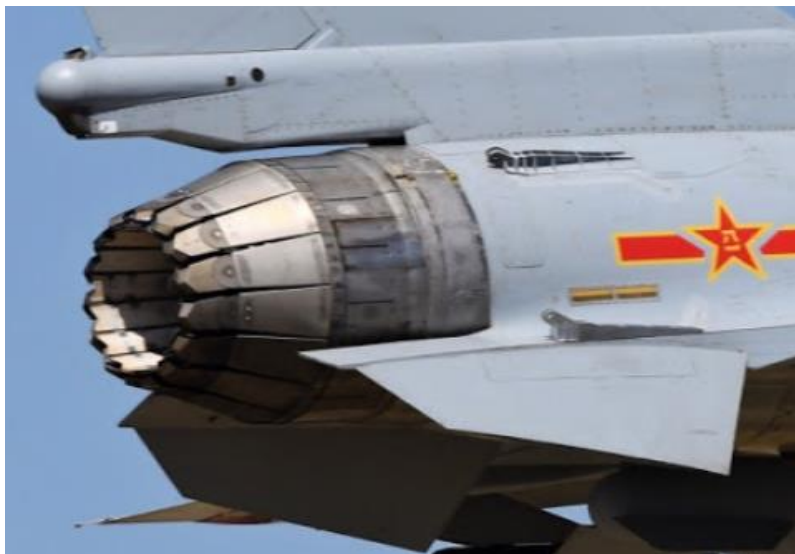
Fig. II.5. Tuyère d'un avion de Combat Chengdu J-10 [36].
