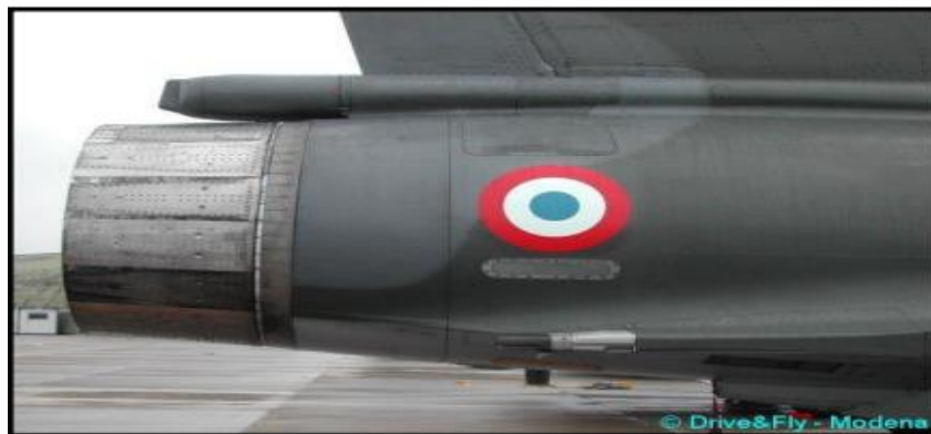
Fig. II.10. Tuyère à section variable [27].
