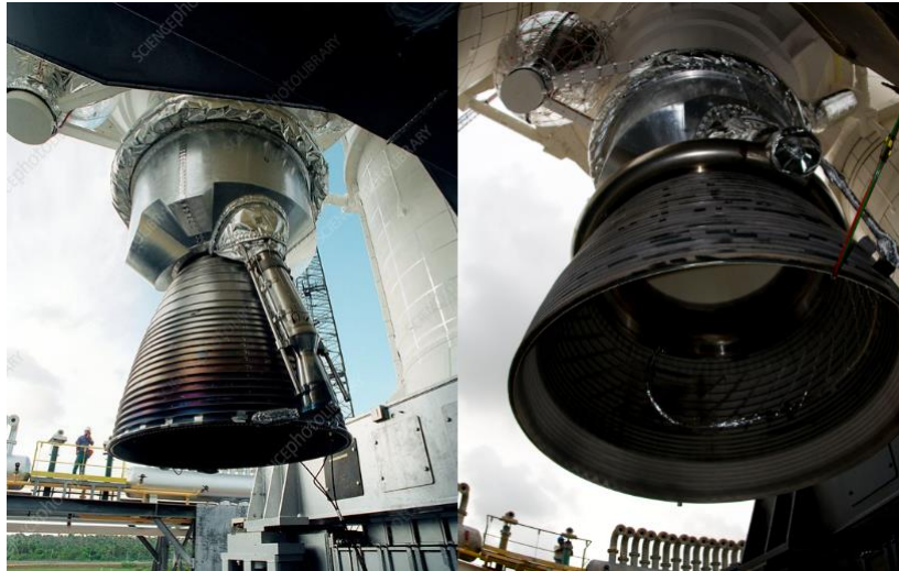
Fig. II.4. Tuyère du moteur Européen Vulcain2 d'Ariane5 [35].
