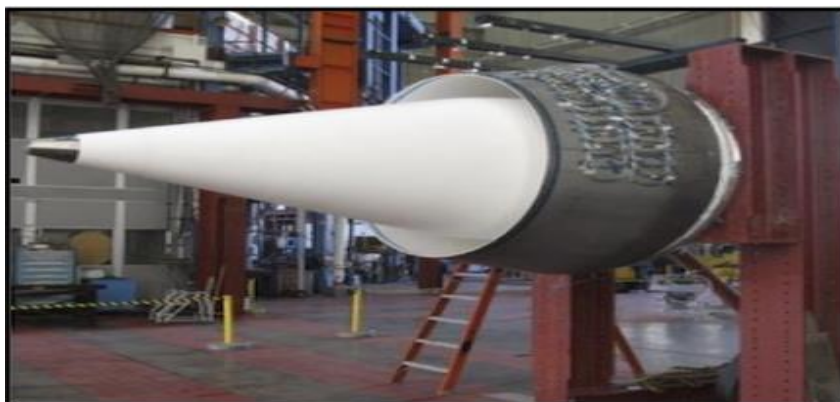
Fig. II.9. Tuyère à noyau centrale [27].
