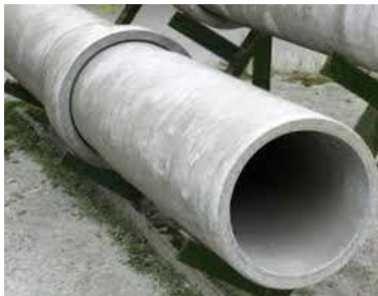
Figure 15 : conduite en amiante-ciment
