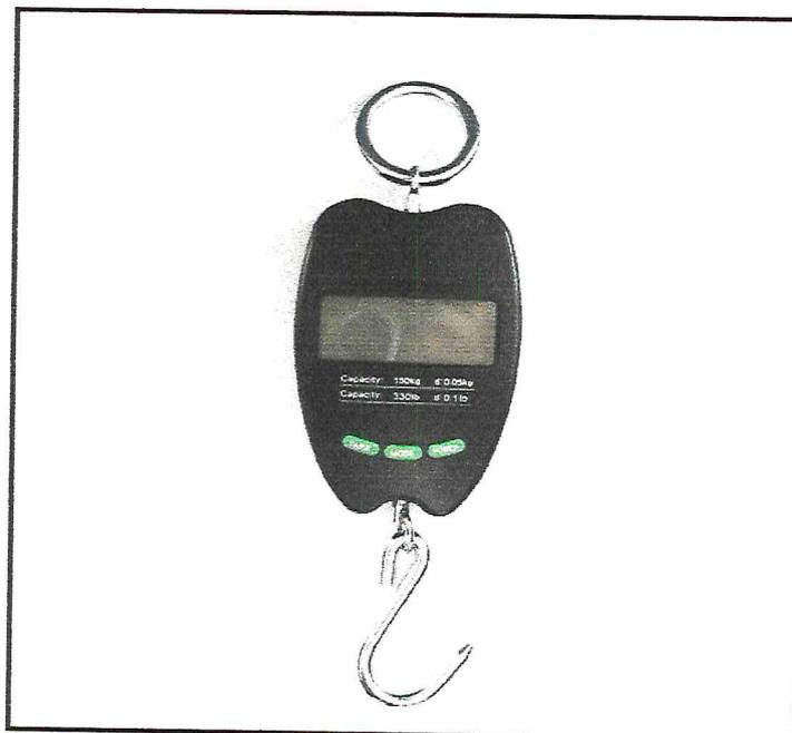
Figure N°09 : Le peson mobile de 200 kg.
