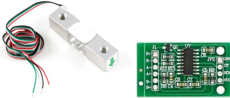
4-3 Capteur de force (à gauche) et son module électronique (à droite)
