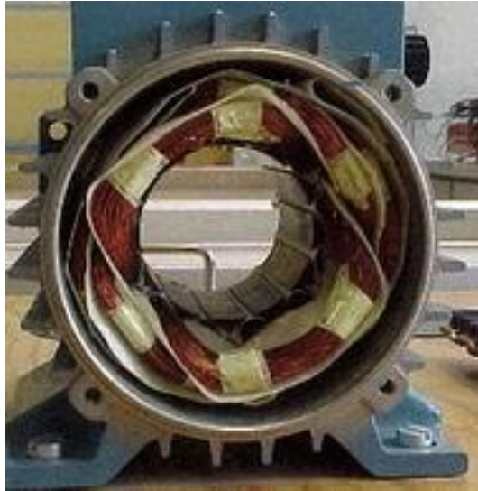
Figure I.2 : Stator d'une machine asynchrone [31].
