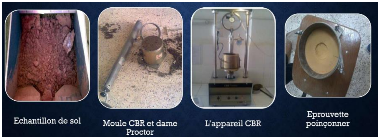
Figure I.4.3 matériels de l'essai CBR
