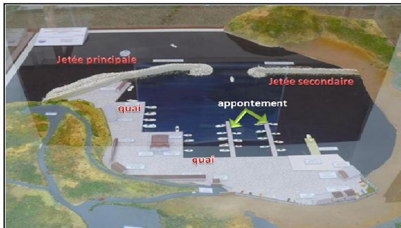
Figure I.6: maquette du port de madagh 'les éléments principale du port [1].
