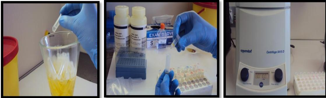
**Figure 41** : dépôt de filtre dans un nouveau tube Eppendorf (Originale, 2015).
