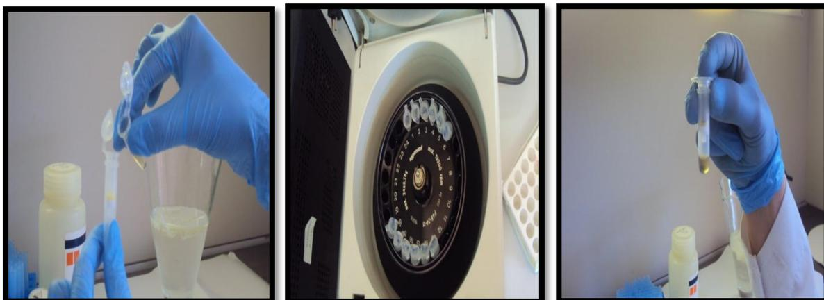
**Figure 38 :** Versement dans des tubes collecteurs et centrifugation rapide (Originale, 2015).
