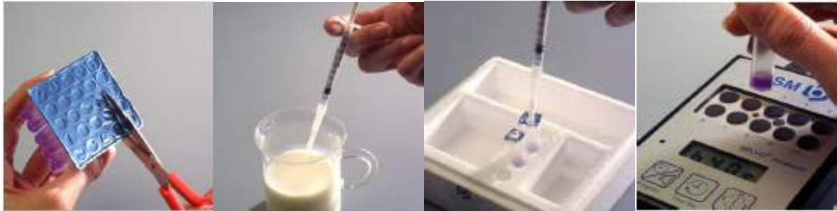
Figure 2.5 : Etapes à suivre en appliquant le Delvotest SP-NT.
