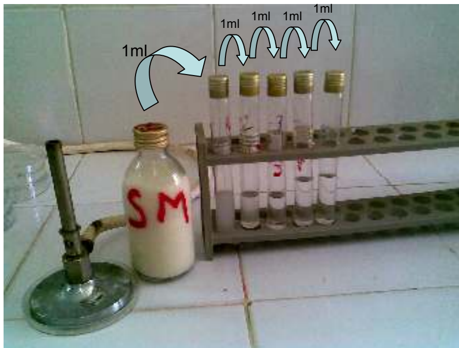
Figure 2.1: Préparation des dilutions décimales ( Originale, 2014 ).
