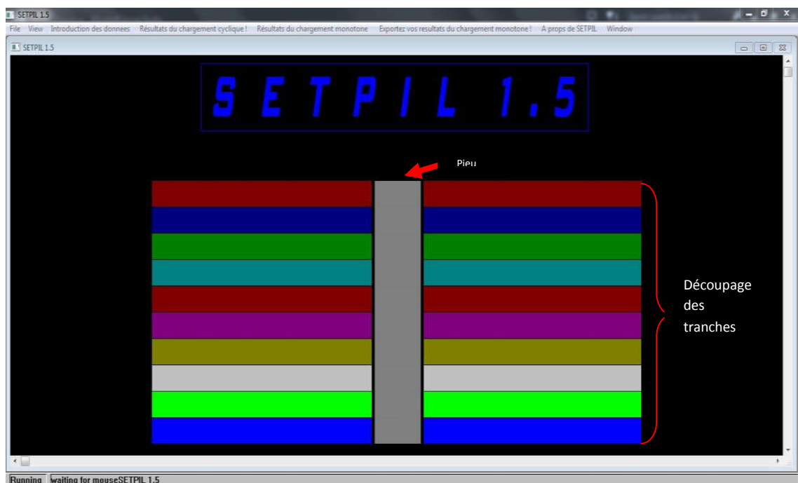
Figure 3.10 : Découpage automatique des tranches du système sol/pieu par SETPIL 1.5
