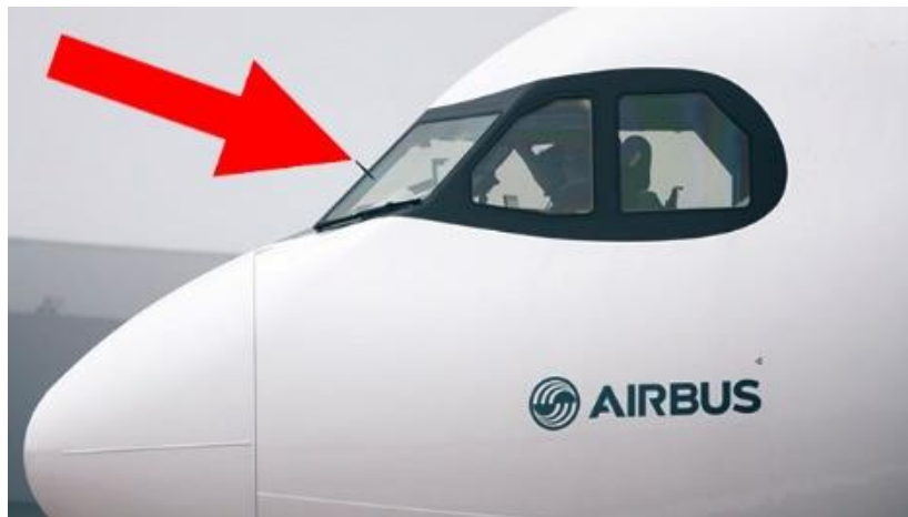
Figure I.11 : détecteur visuel de givre
