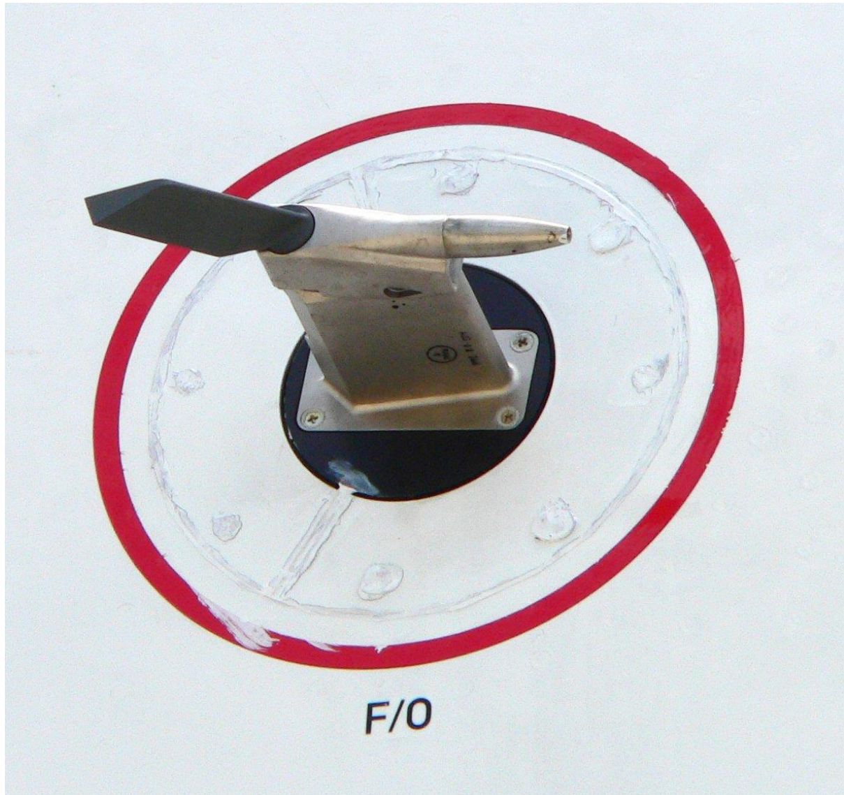
Figure I.12 : tube de Pitot pour la détection manométrique de givre
