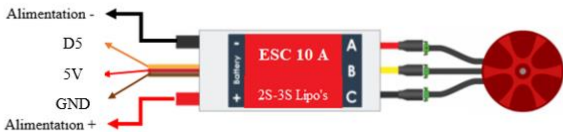
Figure.V.9. cablage du 2éme joystick avec la carte Arduino et le 2éme moteur.
