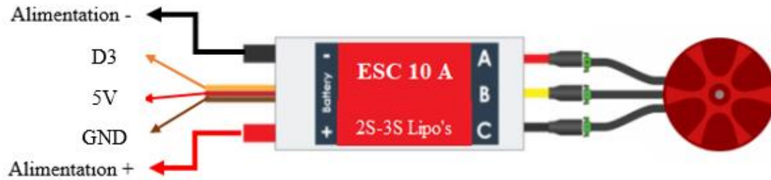
Figure.V.5. Câblage de l’ESC avec le moteur et la carte Arduino.
