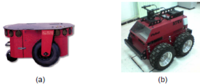
Figure 1.3 : Exemple de robots mobiles différentiels : (a) Robot mobile Pioneer P3-DX, (b) Robot mobile ATRV2 du CDTA.
