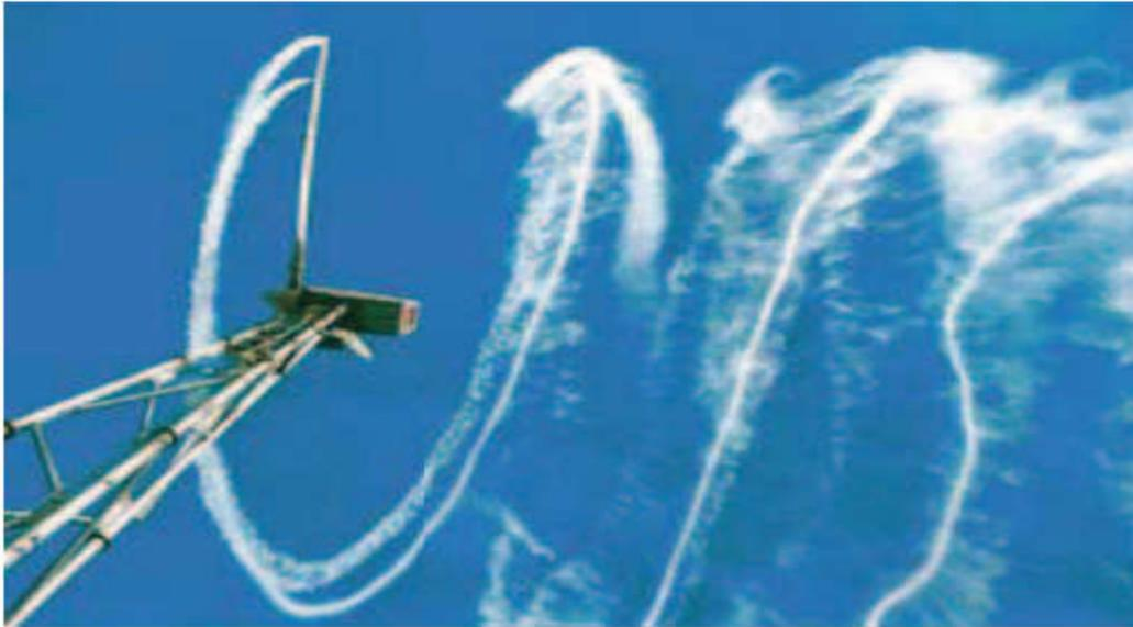
Figure 2.7. Structure du sillage en aval d'une éolienne, révélée par la fumée
