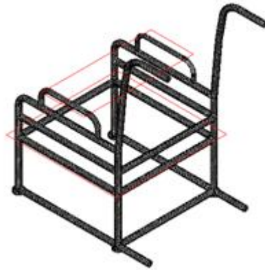
Figure II.8 : Chaise roulante simple sollicitée (maillage)
