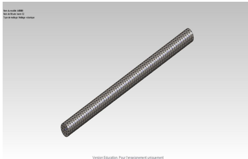
Figure II.32 : Axe (barre) sollicitée (Maillage)
