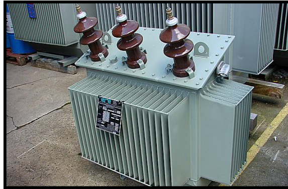
Figure I.4 : transformateur immergé dans l'huile.
