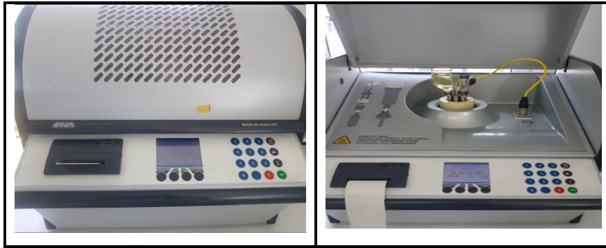
Figure II.8: Appareil tangent delta de mesure du facteur de dissipation (Tan \delta ).
