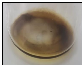
Figure II.5 : dépôts d'huile après le processus de vieillissement.
