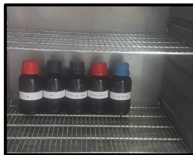
Figure II.1 : Les échantillons dans l'étuve pour le vieillissement.
