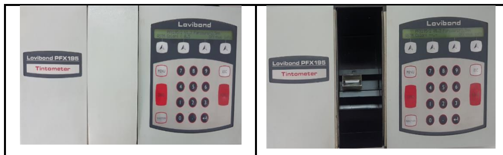
Figure II.6 : colorimètre pour la mesure de la couleur.
