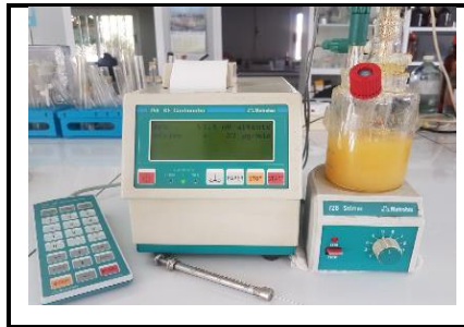
Figure II.7: Appareil COULOMETRE de mesure de la teneur en eau.
