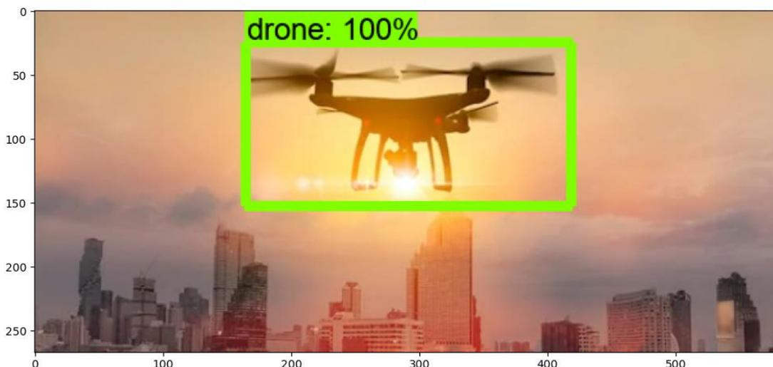
Figure 3.23 : détection d'un drone à 100%.
