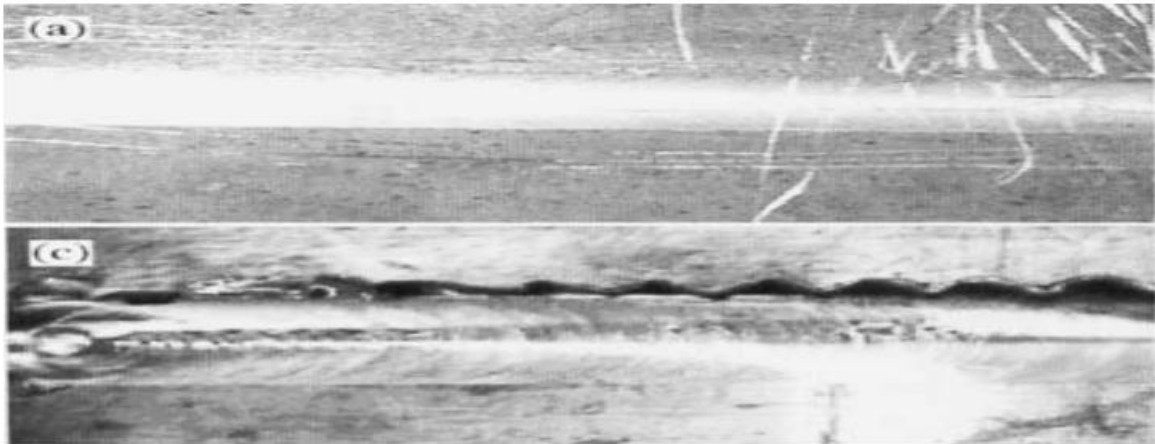
Figure I-5 : joint soudé par FSW pour différents efforts axiaux : a) V_r = 1500 tr/min, V_a = 90 mm/min et F_z = 1470 N ; b) V_r = 1500 tr/min, V_a = 90 mm/min et F_z = 1800 N [16].
