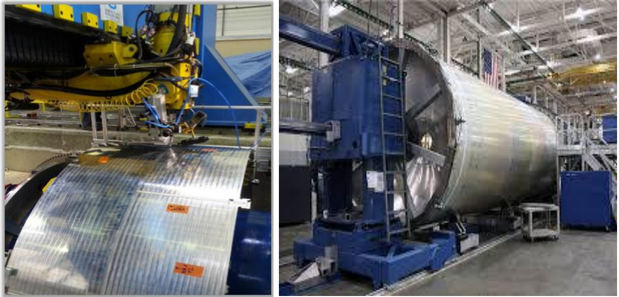
Figure I-15 : Soudage d'un réservoir cryogénique.
