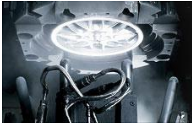
Figure I.14 : Coulée base pression d'une jante BBS. (32)
