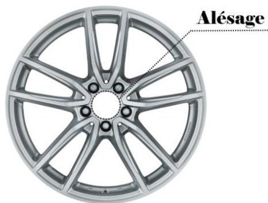
Figure II.4: Alésage d'une jante. (22)
