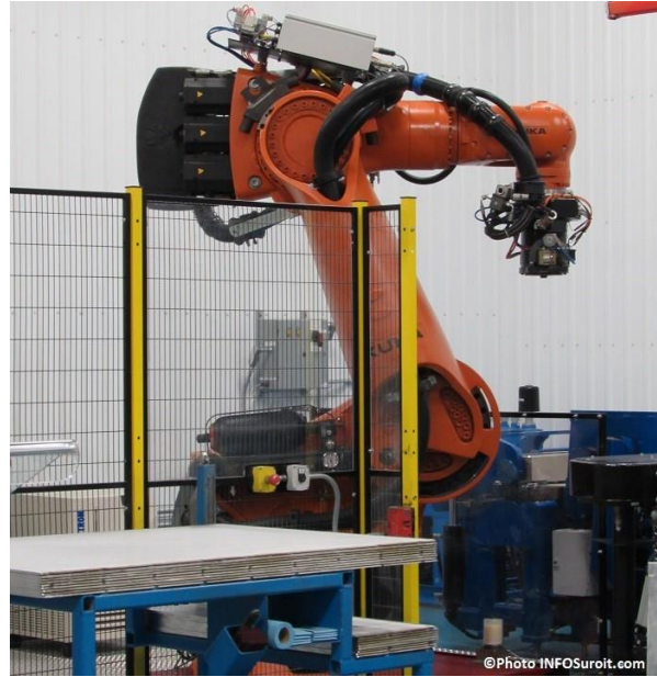
Figure II.11 : Robot asservi pour le FSW doté de sa tête de soudage
